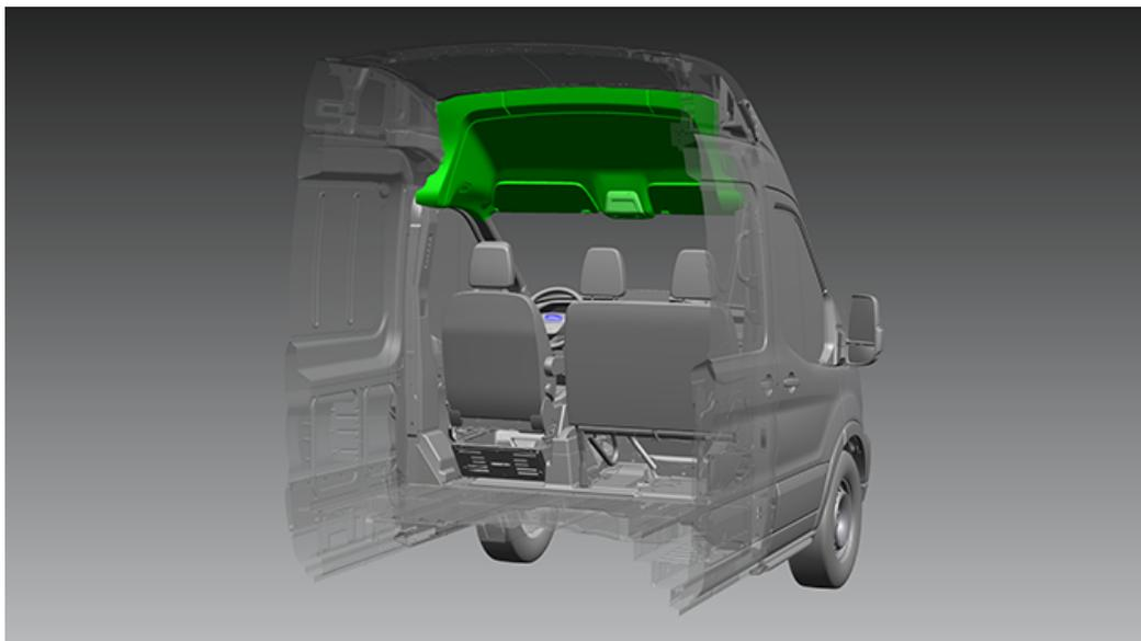
Questa opzione rimuove la console superiore e il padiglione esistenti con scompartimento DIN, sostituendoli con un nuovo padiglione più alto senza ripiano. Ciò permette al conducente di passare al vano di carico del veicolo poiché è disponibile solo senza paratia.
