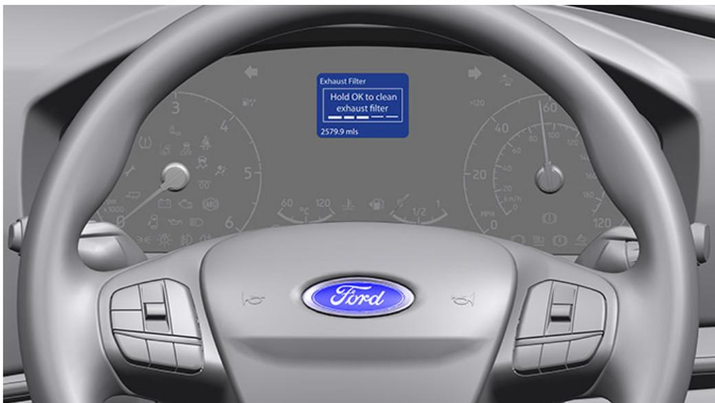
Questa opzione consente al conducente di attivare manualmente la rigenerazione del DPF a veicolo fermo con motore acceso. Il processo richiede tra i 10 e i 20 minuti. Il quadro strumenti segnala quando è necessario eseguire un ciclo di rigenerazione. Raccomandata per i veicoli diesel utilizzati principalmente per brevi tragitti e con momenti di inattività prolungata.
