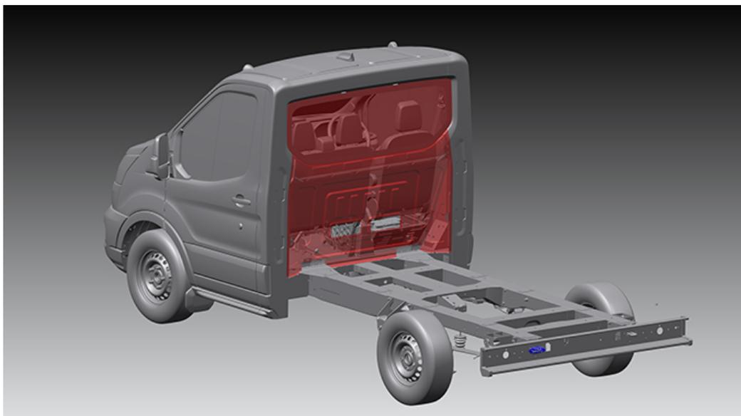
Veicolo allestibile che permette il passaggio dalla cabina all'area di carico. Il veicolo viene consegnato senza pannello posteriore della cabina e senza vetro posteriore. Sono presenti 15 punti di fissaggio al montante centrale per supportare il fissaggio della carrozzeria dell'allestitore.
