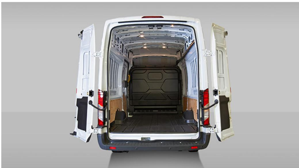
Consente di ripiegare le porte di carico posteriori ai lati della carrozzeria, riducendo al minimo la larghezza totale del veicolo quando le porte posteriori sono aperte.
