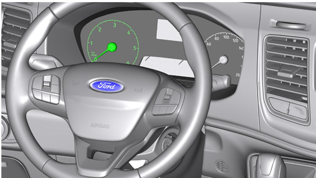
Il controllo regime motore consente al motore di funzionare a un regime elevato in folle. Questa opzione consente la presa di forza elettrica ed elettromeccanica per l'alimentazione di attrezzature supplementari.
