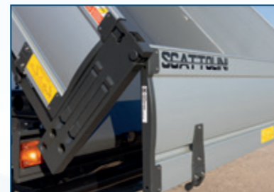
Sponda posteriore in alluminio con doppia apertura
