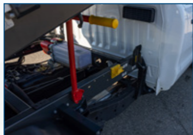
Controtelaio in acciaio
